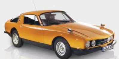
Weniger blechen ohne Blech: Das erste Vollkunststoffauto spart Kraftstoff – dank des geringeren Gewichts. Denn es verzichtet auf ein Blechkleid, nur Motor, Getriebe und Felgen sind aus Metall.
